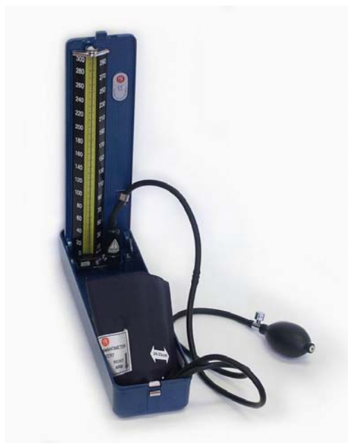
Obr. 1.1 – standardní rtuťový tonometr v kovovém pouzdře s připojenou manžetou a balónkem s odpouštěním ventilem.
