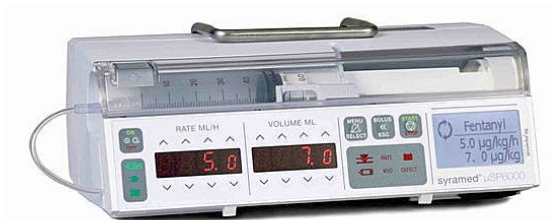
Obr. 6.8: Lineární dávkovač s instalovanou injekční stříkačkou.
