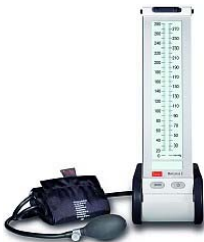
Obr. 3.3 – digitální pseudortuťový tonometr, kde je rtuťový manometr nahrazen digitálním zobrazovacím prvkem, opět je připojena manžeta s balónkem.
