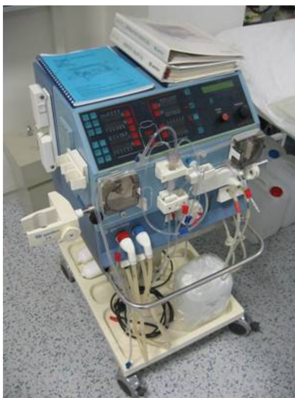
Obr. 6.5: Peristaltické pumpy u hemodialýzy Gambro AK-100.
