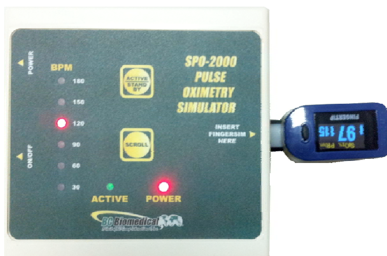
Obr. 4.6: Uspořádání simulátoru \text{SpO}_2 s testovaným pulzním oxymetrem.
