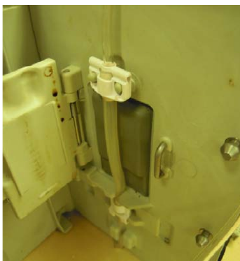
Obr. 6.8: Infuzní pumpa s lineárním peristaltickým pohonem s instalovaným setem.
