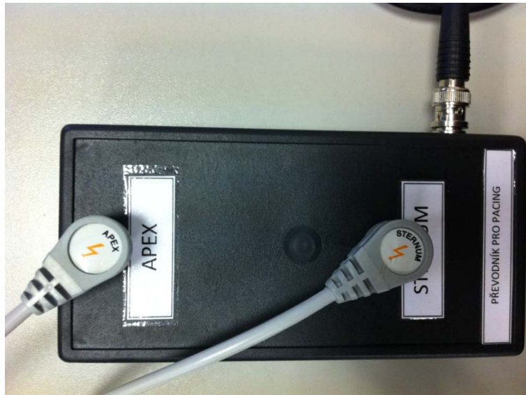
Obr. 3.9: Převodník pro pacing, ukázka připojení stimulátoru a osciloskopu.
