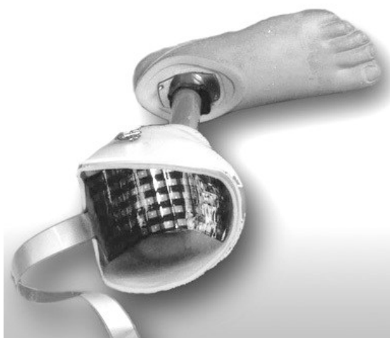
Obr.3: Systém F-Socket, který umožňuje měřit distribuci tlaku v lůžku protézy, (převzato z propagačních materiálů firmy Tekscan).
