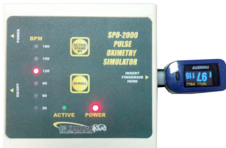
Obr. 4.6: Uspořádání simulátoru SpO 2 s testovaným pulzním oxymetrem.
