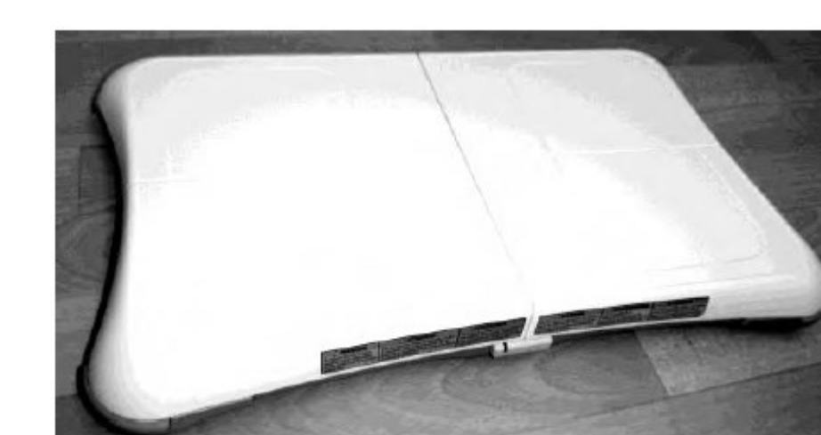
Obr. 4: Stabilometrická plošina firmy Nintendo
